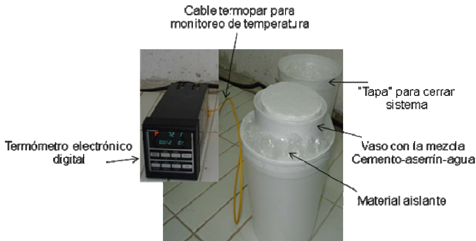
Figura 1. Implementación del sistema térmico para el monitoreo de la temperatura y tiempo máximo de hidratación de las mezclas cemento-aserrín.
