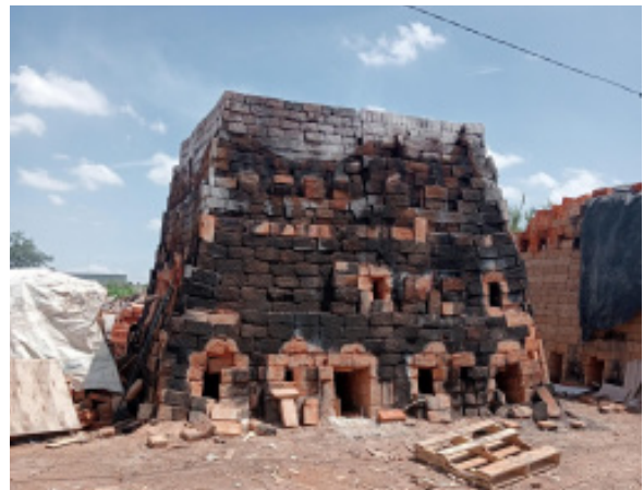
Horno artesanal de ladrillos encendido en ex hacienda Tlaquepaque, jal.
