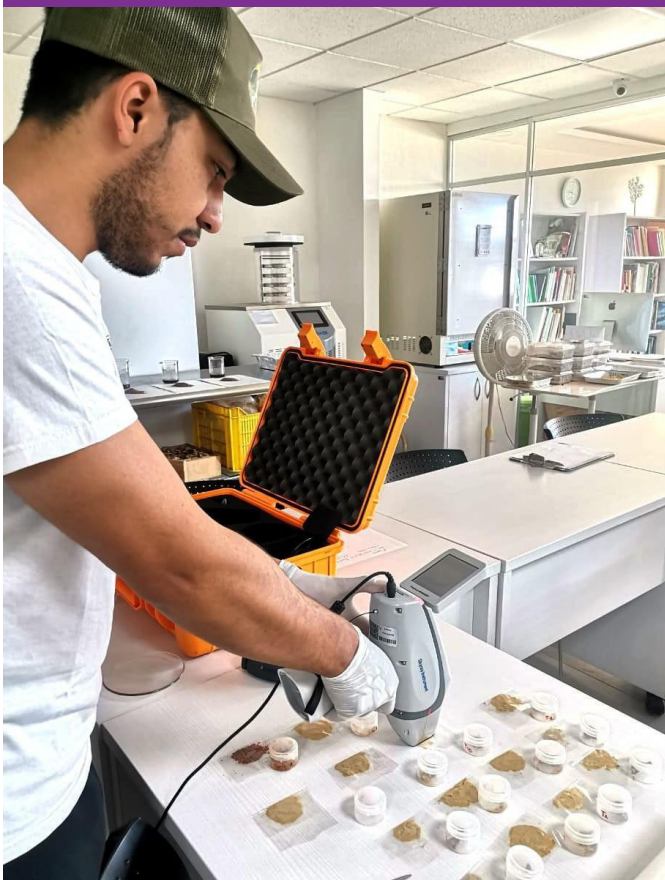
Identificación de metales en sedimento por espectrometría de fluorescencia de rayos X.
